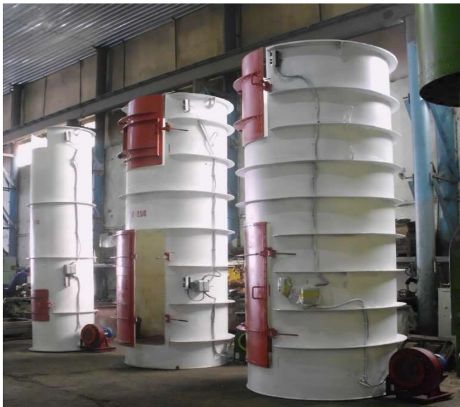
Рисунок 4 – Грузовые пневмолифты трёх модификаций грузоподъёмностью 110, 250 и 500 кг
