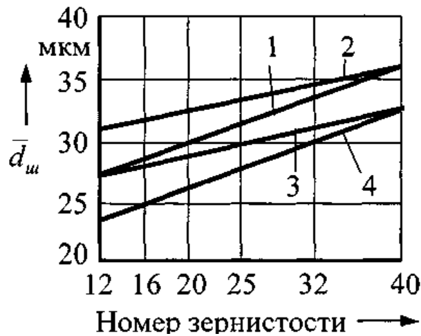
Рисунок 3.8 – Влияние зернистости шлифовального круга на средний размер частиц механических примесей d_{ш} : 1, 3 - v_s = 0,15 мм/мин; t = 10 с; 2, 4 - v_s = 0,8 мм/мин; t = 180 с; 1, 2 - твердость круга С1; 3, 4 — твердость СМ1
